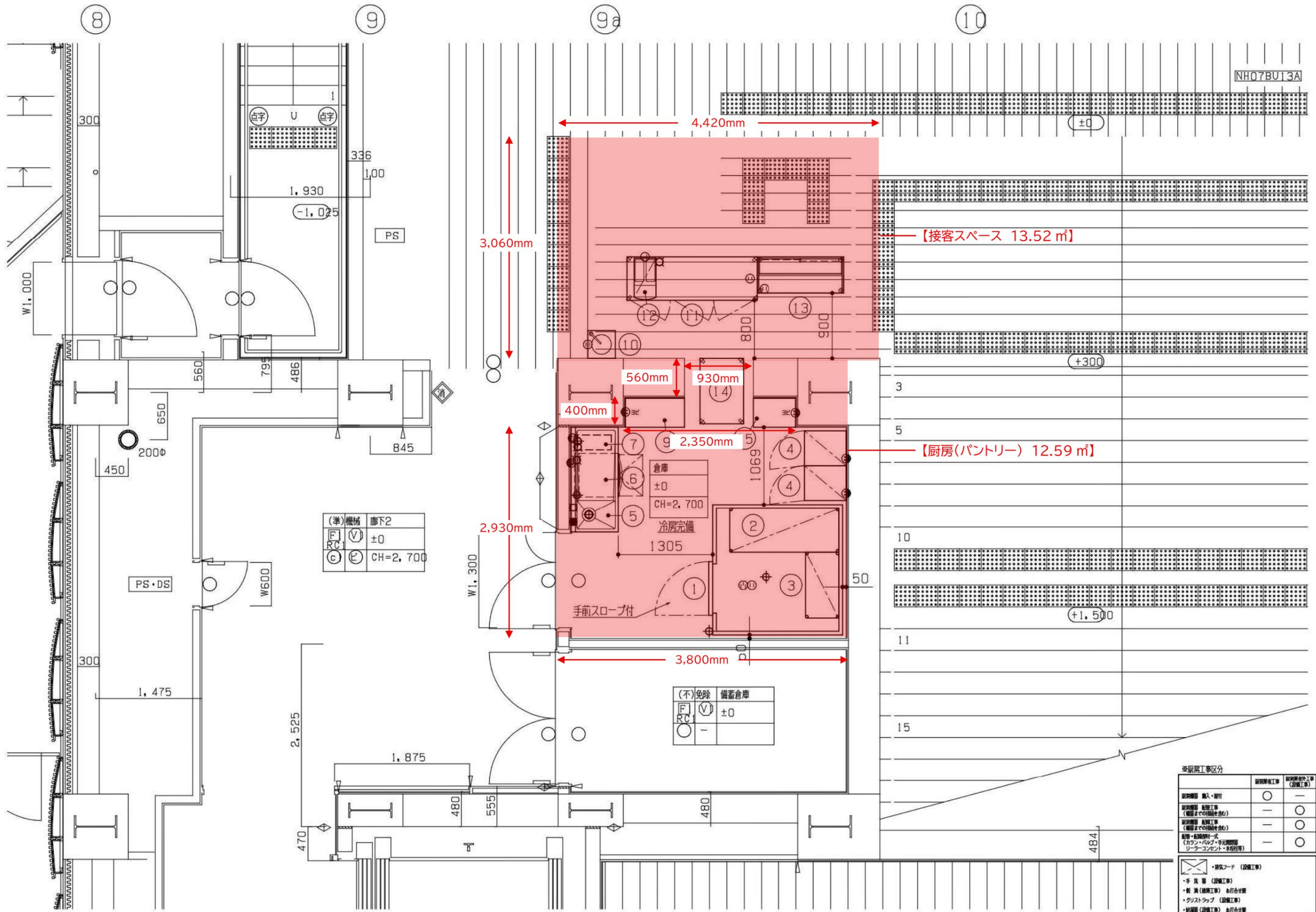
⚠ 当厨房設計図書は、厨房室の床及び仕上材は、不燃材料と見なしてあります。 ⚠ 平面図上の設備シンボルは、機器接続位置です。 ⚠ 2021年6月より、HACCP制度化。
